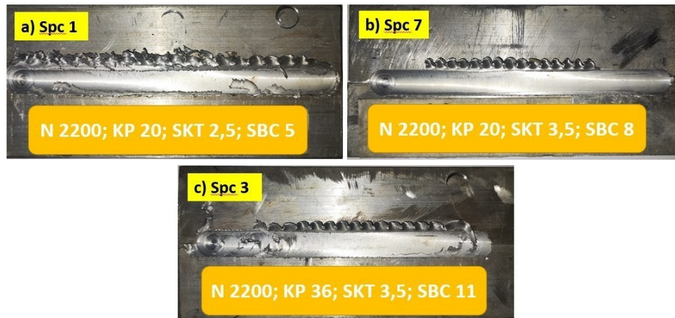
Figur 15: Hasil pengelasan UFSW dipilih 3 spesimen terbaik secara visual.
