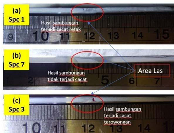
Figur 16: Pengamatan penampang spesimen secara makro.
