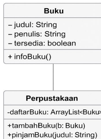
Gambar 2.2 Class Diagram Perpustakaan Sederhana
