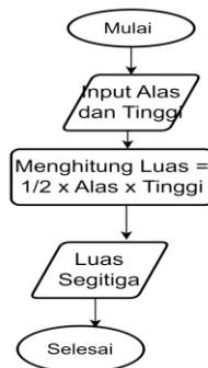
Gambar 1.7: Flowchart Menghitung Luas Segitiga
