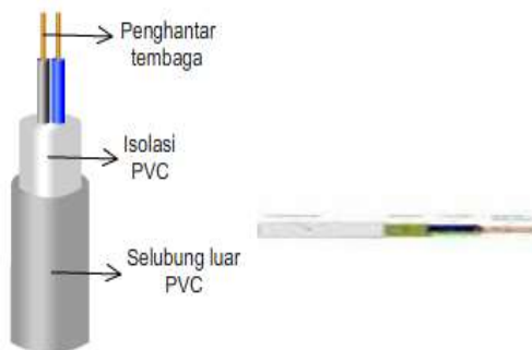
Gambar 2.3 Kabel NYM dengan dua inti
