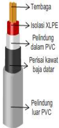
Gambar 2.14 Kabel N2FGBY
