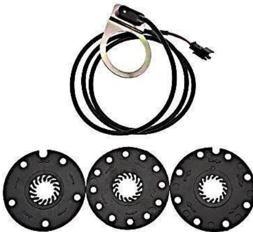
Gambar 3.3. Pedal Assist (PAS)
