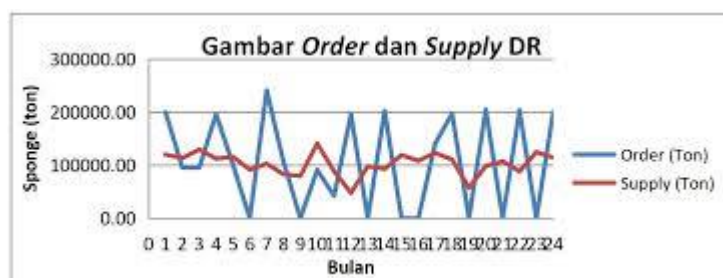
Gambar 9.1: Ilustrasi bullwhip effect pada supply chain
