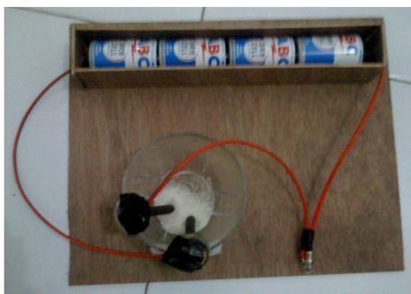
**Gambar 1. Rangkaian Alat Uji Larutan Elektrolit & Non Elektrolit**
